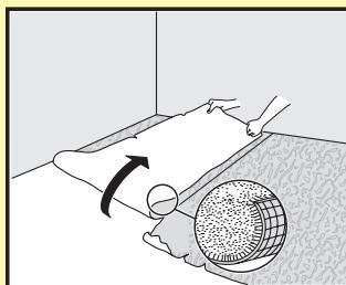
При выполнении монтажа поверх деревянного чернового пола содержание влаги в древесине не должно превышать 10%. Кроме того, поверхность под деревянным черновым полом должна быть абсолютно сухой. При наличии подполья под дощатым полом необходимо обеспечить его вентиляцию. Уберите все препятствия и убедитесь в наличии достаточной вентиляции (минимум 4 см<sup>2</sup> общей площади вентиляционных отверстий на м<sup>2</sup> пола).
