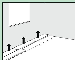
Нанесите на пол слой винилового клея примерно по ширине двух первых рядов. Стого следуйте инструкциям на упаковке винилового клея. Рекомендуется использовать специально разработанный фирменный виниловый клей.
