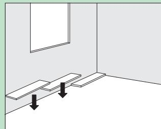
Панель винилового пола можно легко обрезать с помощью ножа, держа ее лицевой стороной вверх. Чтобы обрезать планку, наметьте линию и с помощью ножа сделайте глубокий надрез в поверхности. Затем разломите планку двумя руками.
